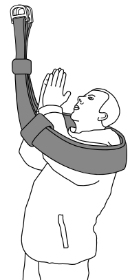
Einstieg bei geschlossener Rettungsschlinge
